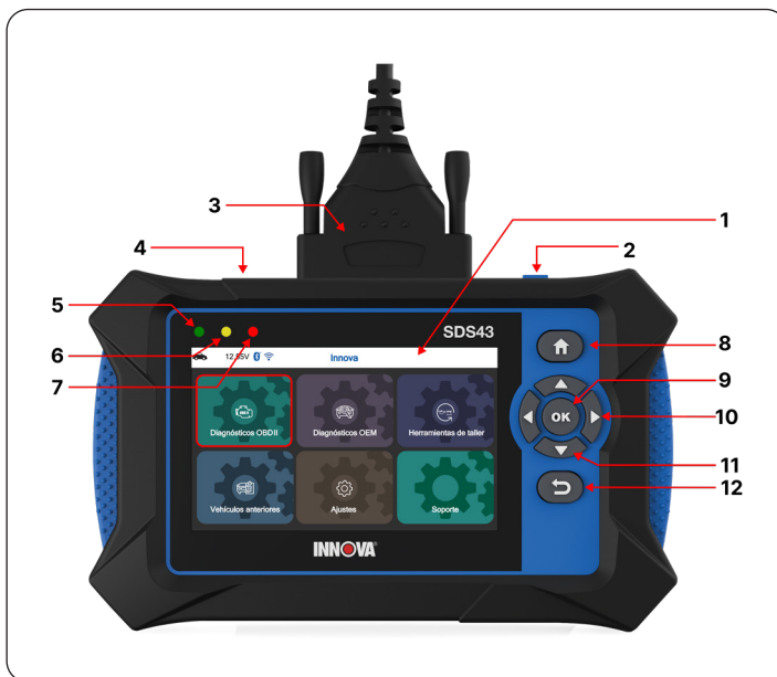
Figura 1. Controles e indicadores de la tableta
